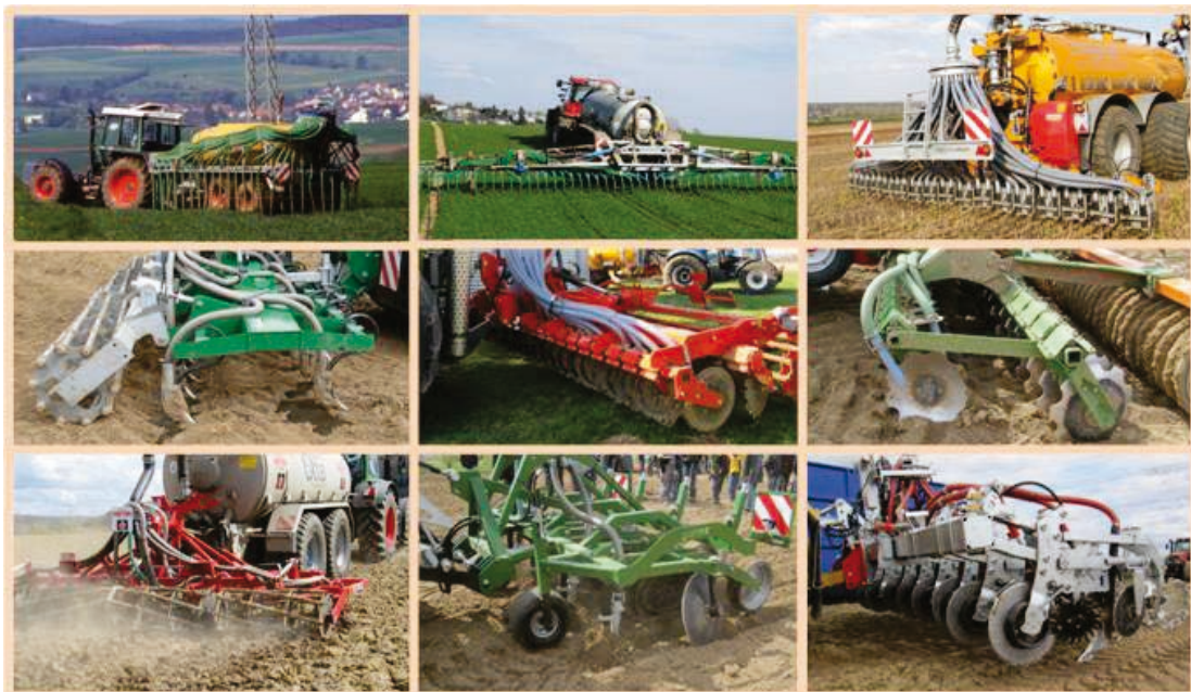
Abb. 3: Verteiltechniken für die streifenförmige Ablage flüssiger Wirtschaftsdünger
