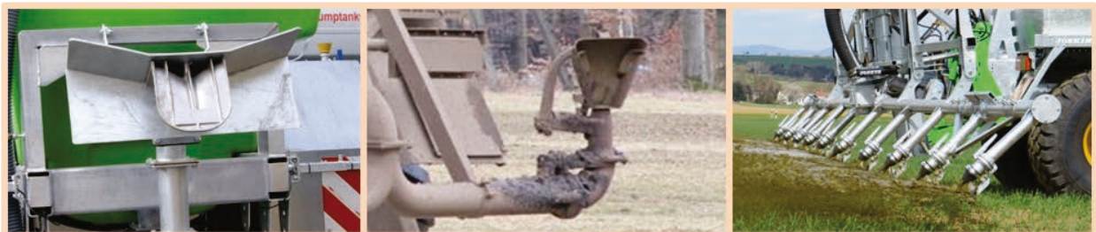
Abb. 2: Güllebreitverteilung durch Prallkopfverteiler, Schwenkverteiler und Düsenbalken Düngestoffe verloren gehen.
