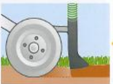
Die Scheiben schneiden in den Boden, die Gñlle flñuft komplett in den Schlitz.
