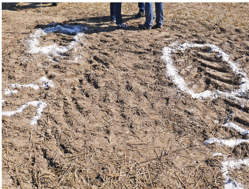
Demonstration des Bodendrucks bei unterschiedlichem Reifeninnendruck (links 1,5 und rechts 1,0 bar). Fotos: Hildebrandt
