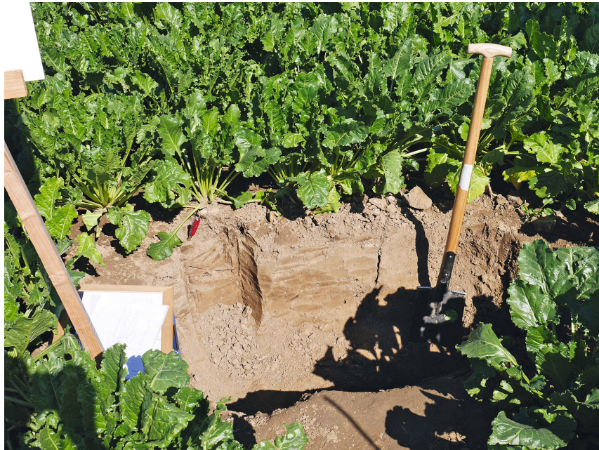
Deutliche Schadverdichtung mit horizontalem Plattengefüge im Bodenprofil eines Rübenschlages.
